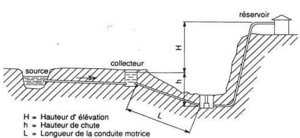
Si Q est la quantité d'eau débitée par la source ou le ruisseau, la quantité q d'eau remontée vers le réservoir d'utilisation, est calculée par la formule :
