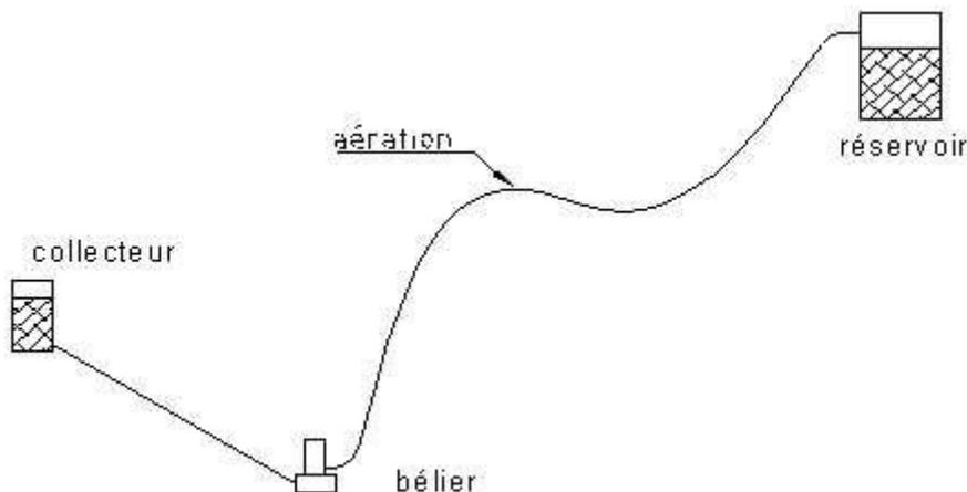
La conduite d'alimentation peut être réalisée en tuyaux plastiques; ceux-ci doivent cependant être adaptés à la pression à laquelle ils doivent pouvoir résister et qui dépend de la hauteur de remontée (1 kg/cm<sup>2</sup> par 10 m de remontée).
