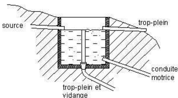
Le collecteur peut avoir n'importe quelle grandeur, par exemple un tuyau de ciment de dia 0.6 à 1 m de diamètre. Toutefois, la conduite motrice doit toujours être suffisamment couverte d'eau, au moins 30 à 40 cm d'eau. La quantité excédentaire d'eau (différence entre le débit de la source et le débit moyen de la conduite motrice) sera évacuée par un dispositif de trop plein.
