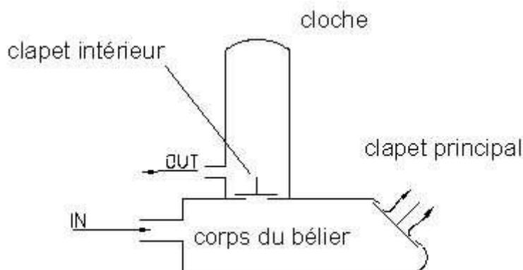
Dans un premier temps, le clapet intérieur du réservoir est fermé et le clapet du corps principal est ouvert. L'eau en provenance de la source s'écoule librement à travers la conduite motrice et le corps du béliet en prenant de la vitesse et en s'échappant par le clapet principal. A un moment donné, grâce à la vitesse acquise, le clapet principal se ferme brusquement en provoquant "un coup de béliet", phénomène bien connu qui, en d'autres lieux, peut avoir des effets dévastateurs. Ici, ce
