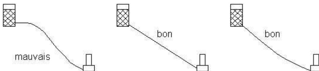
La conduite motrice devant résister aux "coups de béliet" il est indispensable qu'elle soit réalisée en matériaux rigides tels que tuyaux d'acier ou de fonte. Les tuyaux en matière plastique sont à proscrire pour cet usage à cause de leur élasticité.
